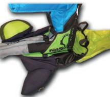
Ziehe anschließend die Nase so über die Schuhe, dass das Gurtzeug leicht unter Spannung steht. Im Anschluss kannst du die Klettschlaufen in die hinteren, oberen D-Ringe einhängen.
